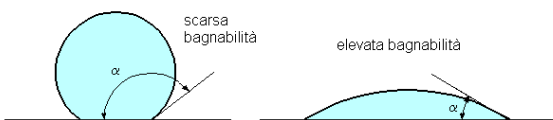
Figura 10 - L'angolo di contatto di un liquido con un solido viene utilizzato come indice di bagnabilità. Per \alpha < 90^\circ il liquido bagna la parete (es: acqua su vetro), per \alpha > 90^\circ il liquido non bagna la parete (es: mercurio su vetro). Se \alpha = 0^\circ si dice che il liquido bagna perfettamente la parete.
